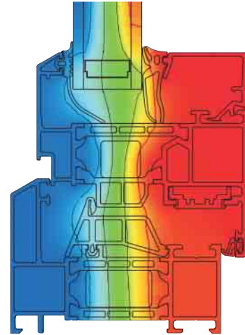
Schüco Fenster AWS 70 RL.HI Reduzierte Wärmeverluste, Maßstab 1:2 Schüco Window AWS 70 RL.HI Reduced heat losses, scale 1:2
