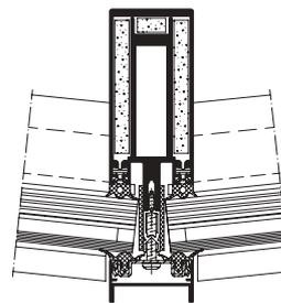
Schnitt segmentierter Pfosten, Maßstab 1:5
